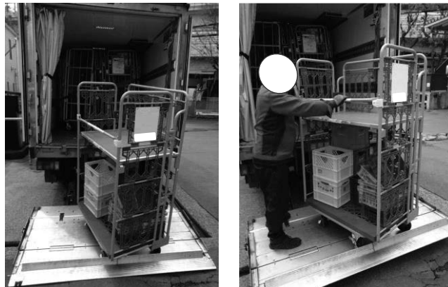
図 1 U 字型の RBP を昇降板に積載した様子 (例)
